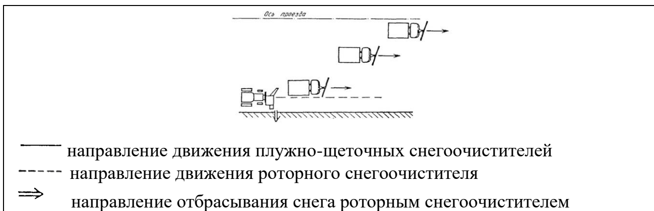
Рисунок 8-Схема расчистки проезжей части улиц колонной плужно-щеточных снегоочистителей и перекидывание снега роторным снегоочистителем
