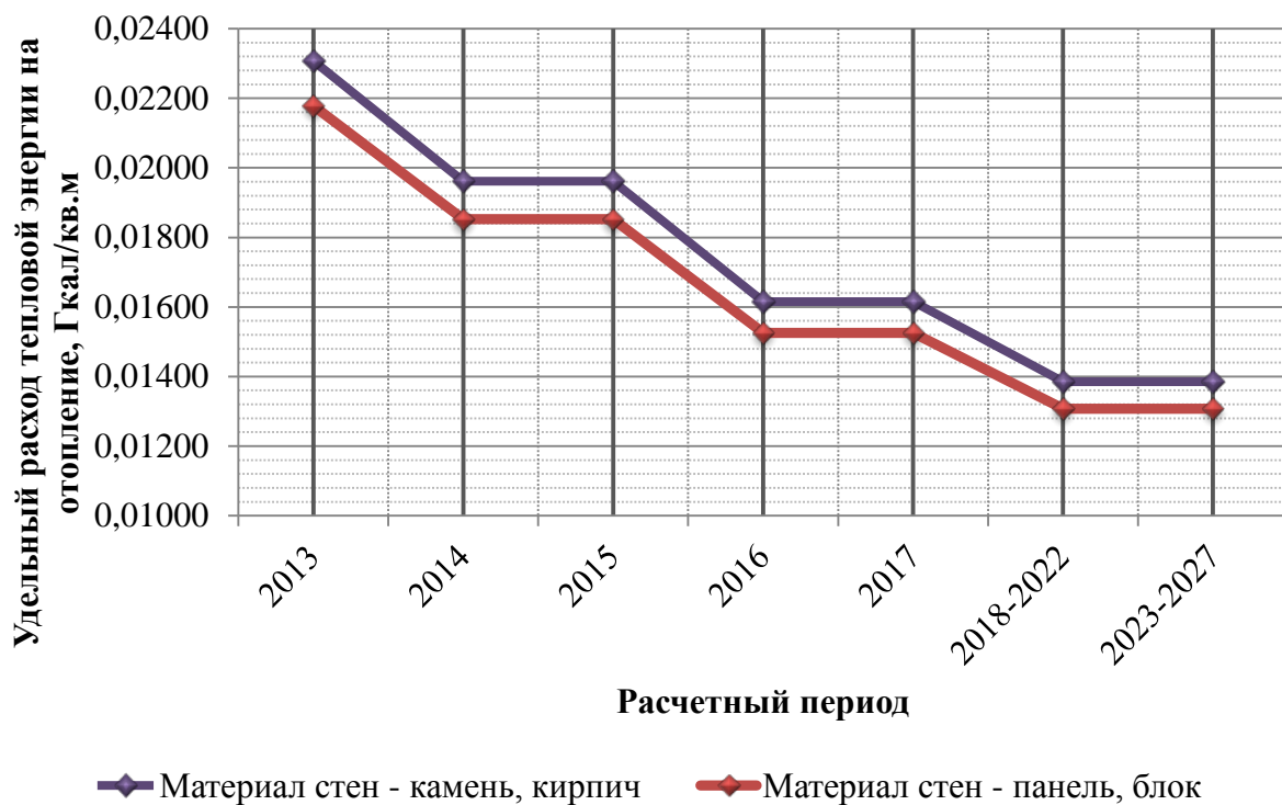
Рисунок 11. Удельные расходы тепловой энергии на отопление
